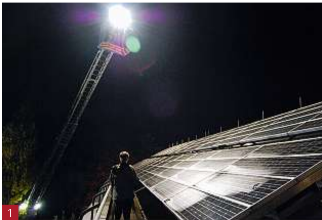
1 Situation am Solargenerator bei Beleuchtung des PV-Generators der Teilanlage West der PV-Testanlage der BFH-TI durch zwei Scheinwerfer von je 1 kW am 27.10.2010 im Abstand von wenigen Metern durch die Feuerwehr Burgdorf. Die vorne liegenden Module werden relativ stark (teilweise mit Bestrahlungsstärken von bis gegen 150 Lux) bestrahlt, die weiter entfernten Arrays in grösserem Abstand aber viel schwächer.
