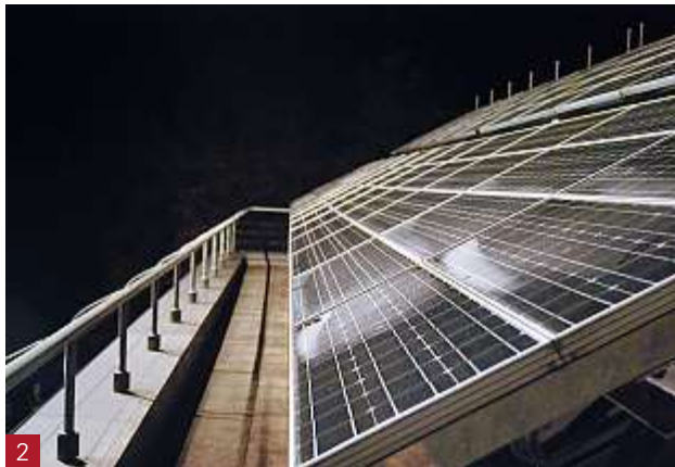
2 Detailaufnahme bei Beleuchtung des Solargenerators der Teilanlage West der PV-Testanlage der BFH-TI durch zwei Scheinwerfer von je 1 kW. Trotz dem Einsatz von zwei in leicht verschiedene Richtungen strahlenden Scheinwerfern ist es relativ schwierig, einen ausgedehnten Solargenerator einigermaßen homogen zu bestrahlen.
